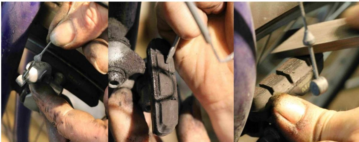
Ein Wechsel ist nötig, wenn am Bremsbelag keine Querrillen mehr vorhanden sind. Der Wechsel ist relativ einfach, es müssen jedoch zuvor neue Bremsschuhe (Bremsbelag und Träger bilden eine Einheit) gekauft werden. Cantilever-Bremsen und V-Brakes erfordern unterschiedliche Bremsschuhe.
