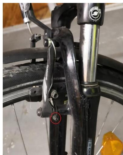
Ist die Distanz vom Bremsbelag zur Felge nicht symmetrisch, kann die Rückstellfeder (wenn vorhanden) justiert werden. Dazu gibt es auf beiden Seiten der Bremse Feststellschrauben. Je nach Modell kann sich die Position unterscheiden (siehe Bild, V-Brake, Stellschraube ist rot markiert).
