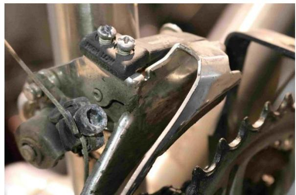
Werden die Gänge noch immer nicht sauber geschaltet, wird die Zugspannung mit der Stellschraube am Schalthebel angepasst.
