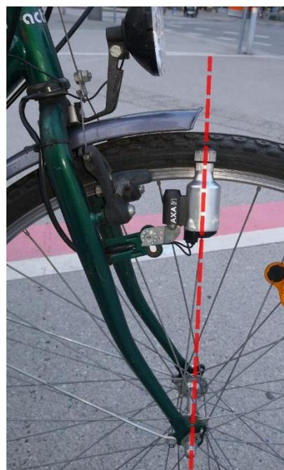
Bei Seitenläufer- und Nabendynamo werden auch die Anschlüsse an Dynamo und Lichtquelle überprüft und ggf. werden die Kabel wieder angeschlossen. Wird noch immer kein Licht erzeugt, liegt ein Defekt im Dynamo, der Verkabelung oder der Lichtquelle vor. Mittels eines elektrischen Messegeräts (Ohmmeter) kann der Fehler lokalisiert und behoben werden. [Details siehe Technische Anleitung, Schulen-Mobil S19](#)
