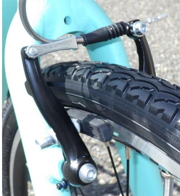
Zuerst sollten die Bremsbeläge überprüft werden.
