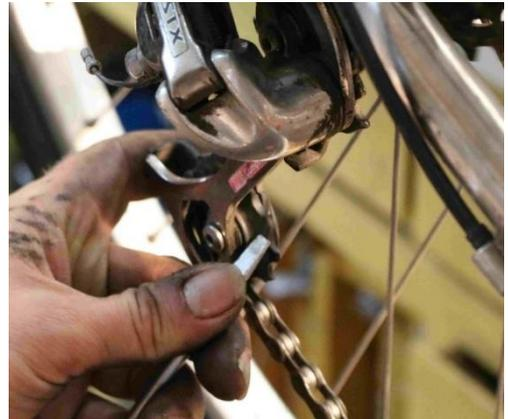
Bei hartnäckigen Schmiermittelrückständen können spezifische Fahrradprodukte oder andere fettlösende Mittel (z.B. WD40-Spray) verwendet werden.
